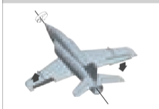
飞行中副翼右转 --- 舵面修正图示
